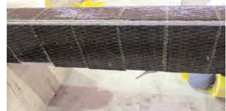
Fig. 13. Exemplu de consolidare de grindă în sistem FRP, laboratorul Dipartimento di Meccanica Strutturale, Università degli Studi di Pavia
